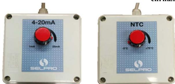
Моделирующие устройства ZCSIM позволяют симитировать выходной сигнал 4-20mA, 0-10V, NTC, для проверки работы регулятора скорости вращения и контроллера в действующей системе. Устройство представляет собой пластиковую коробку с поворотным регулятором, внутри на печатной плате установлен 10-оборотный потенциометр. Для электрических подключений используется 2-х или 3-х жильный провод. Совместим со всеми контроллерами принимающих данный сигнал.
