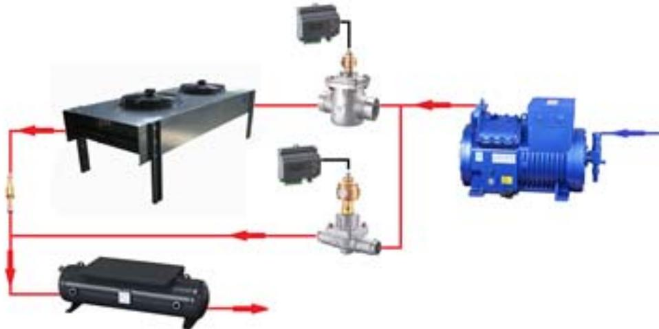
**Вариант установки вентилей DHV с контроллером HC-10 для регулирования давления кипения в испарителях с различными температурными режимами**
