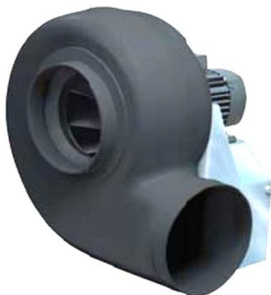
Радиальные вентиляторы одностороннего всасывания серии EPND для агрессивных сред производства "Rosenberg" (Германия) имеют пластиковый корпус, внутри размещается рабочее колесо из полипропилена, лопатки которого загнуты назад. Стандартный электродвигатель имеет внешний статор и короткозамкнутый ротор IP55.
