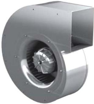
Центробежные вентиляторы одностороннего всасывания серии ERA производства "Rosenberg" (Германия) имеют металлический корпус, внутри размещается центробежное рабочее колесо, устанавливаемое непосредственно на ротор. Специальная конструкция ротора позволяет существенно снизить частоту вращения при увеличении нагрузки. Стальные лопатки рабочего колеса загнуты вперед.
