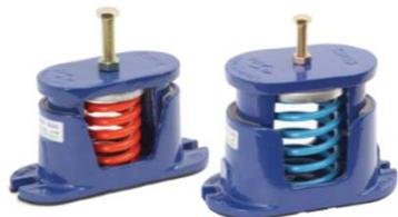
Опора имеет пружину между верхним и нижним корпусами. Болт с гайкой верхнего корпуса при нажатии на пружинный колпачок обеспечивает распределение нагрузки. Антифрикционный элемент крепится между верхним и нижним корпусами, что несколько снижает трение, вызванное относительным смещением влево-вправо и сверху вниз при работе оборудования. CR-прокладка, прикрепленная к нижней части корпуса, компенсирует вибрацию пружины.
