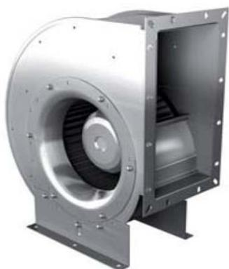
Центробежные вентиляторы одностороннего всасывания серии ERA производства "Rosenberg" (Германия) имеют металлический корпус, внутри размещается центробежное рабочее колесо, устанавливаемое непосредственно на ротор. Стальные лопатки рабочего колеса загнуты вперед.
