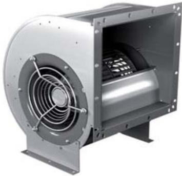
Центробежные вентиляторы двустороннего всасывания серии DRA производства "Rosenberg" (Германия) представляют собой металлический корпус, внутри размещается центробежное рабочее колесо (барaban) с двумя рядами стальных лопаток. Лопатки рабочего колеса загнуты вперед. Рабочее колесо непосредственно устанавливается на ротор.
