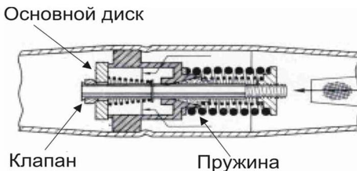
**Рекомендуемая схема зимнего пуска с использованием дифференциального клапана "ORD-4".**
