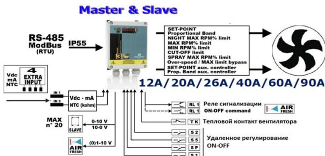
Серия RGM300 предназначены для ручного или автоматического регулирования асинхронных (АС), трехфазных двигатели, осевых и центробежных вентиляторов, с устройствами системы контроля. Имеет 2 вход и доступны 12 различных режимов регулирования.
