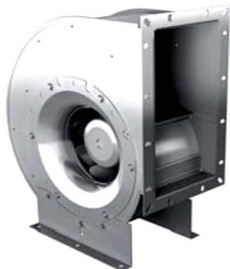
Радиальные вентиляторы одностороннего всасывания серии ЕНА производства "Rosenberg" (Германия) имеют металлический корпус, внутри размещается центробежное рабочее колесо, устанавливаемое непосредственно на ротор. Алюминиевые лопатки рабочего колеса загнуты назад. Направление вращения рабочего колеса - по часовой стрелке, если смотреть по направлению забора воздуха.
