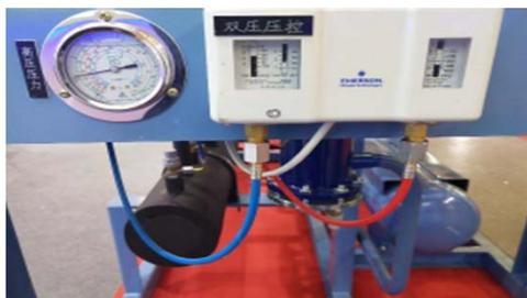
Гибкие капиллярные трубки имеют высокую эластичность, способны поглощать вибрации и частично снижать шум.
