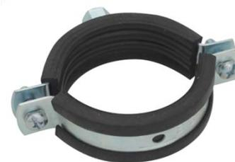
Хомуты тестированы и сертифицированы согласно RAL-GZ 655/B. Макс. допустимая нагрузка (Fa,z) была рассчитана статистическим методом определения пределов прочности, исходя из макс. допустимой деформации в 1,5 мм или 2 % от номинального диаметра трубы.
