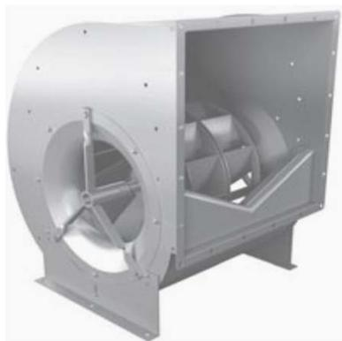
Радиальные вентиляторы двустороннего всасывания серии DHA производства "Rosenberg" (Германия) представляют собой металлический корпус с установочными кронштейнами, внутри размещается центробежное рабочее колесо с двумя рядами алюминиевых лопаток. Лопатки рабочего колеса загнуты назад. Рабочее колесо непосредственно устанавливается на ротор. Направление вращения рабочего колеса - против часовой стрелки, если смотреть по направлению забора воздуха.
