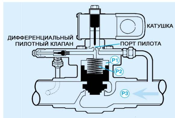
При подаче напряжения на катушку порт пилота будет перекрыт. Давление P1 уравняется с давлением на выходе регулятора через уравнительное отверстие в поршне. После того как разница давлений до и после поршня приодалают силу действия пружины (0,14 бар) поршень поднимется в верхнее положение и регулятор будет полностью открыт.
