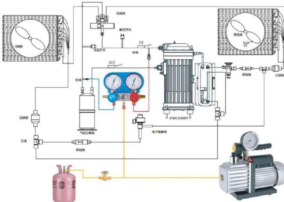
**Рис. 6 Подключение для вакуумирования и заправки системы**
