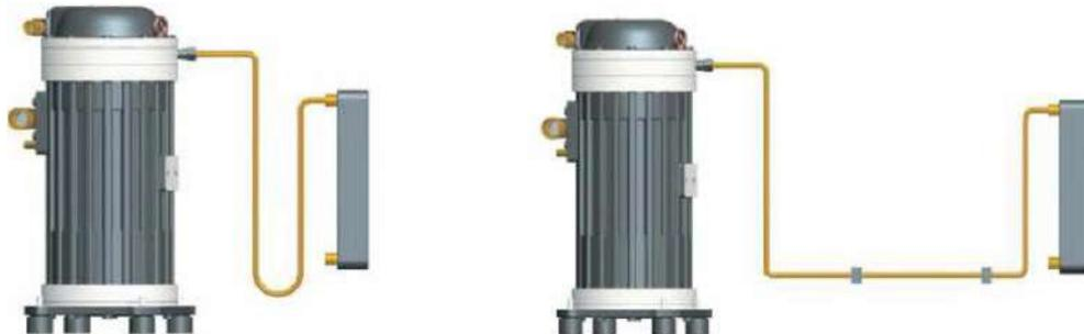
**Рис. 4 Типичное расположение линии всасывания.**
