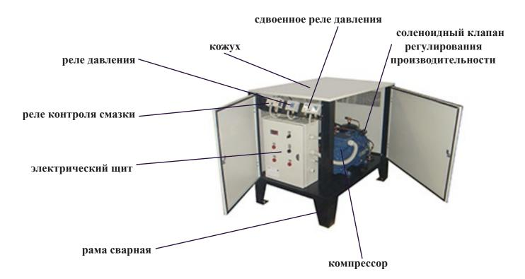
Благодаря оптимальной компоновке элементов и особенностям конструкции компрессора Bock агрегаты серии АП-НG удобны в техобслуживании: при выходе из строя электродвигателя его можно легко заменить, не демонтируя компрессор.
