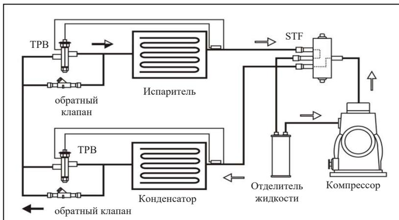
В режиме работы **ОХЛАЖДЕНИЕ**, на катушку четырехходового вентиля напряжение не подается, газ с нагнетания компрессора подается в конденсатор. Жидкий хладагент через обратный клапан поступает к ТРВ и, расширяясь, попадает в испаритель. Далее газ через четырехходовой вентиль поступает на всасывание компрессора.
