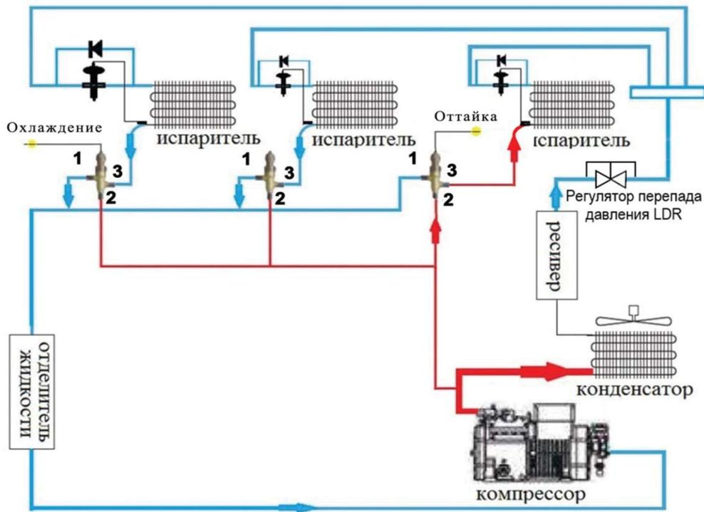
**Вариант установки вентилей DSV с контроллером HC-10**
