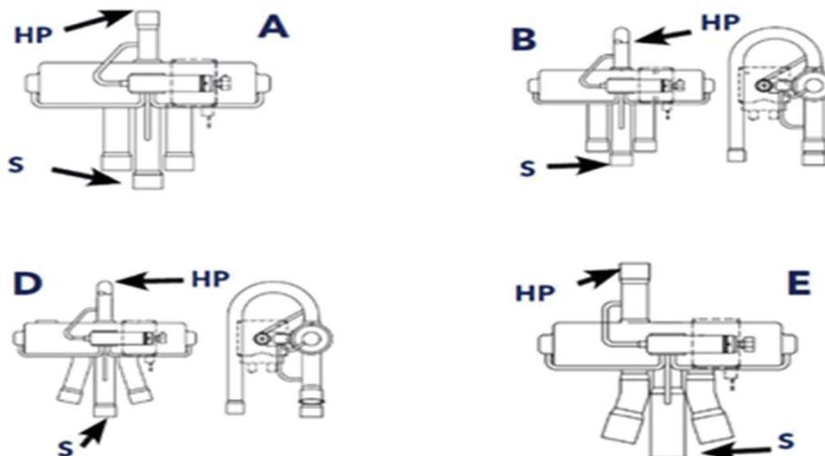
S - всасывание, HP- высокое давление
