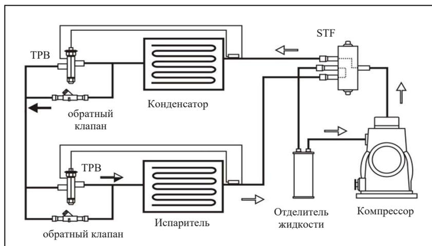
При подаче напряжения на катушку четырехходовой вентиль изменяет направление движения хладагента и горячий газ с нагнетания компрессора поступает в теплообменник, который начинает выполнять функцию конденсатора, тем самым работая в режиме **НАГРЕВ**. Сконденсировавшийся хладагент проходит через обратный клапан и поступает к ТРВ. Выкипание происходит в теплообменнике, ранее выполнявшем функцию конденсатора. Далее газ через четырехходовой вентиль поступает на всасывание компрессора.
