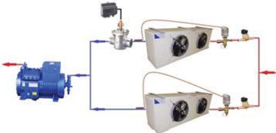
**Вариант установки вентилей DHV с контроллером HS888 для плавного открытия и закрытия в системах с оттайкой горячим газом**
