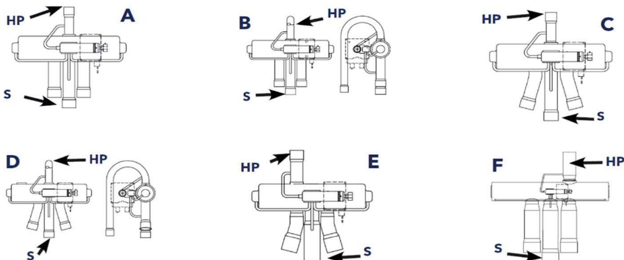
S - всасывание, HP- высокое давление
