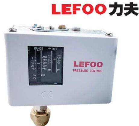
IP44, 10A@250VAC, рабочий диапазон температур -10 ... +110°C, Тип электро контакта-SPDT, соединение 1/4SAE. подключение 1/4SAE, габаритные размеры 83,5\*87\*44мм, масса 0,32кг.
