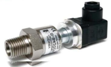
Рабочее давление 0...46 бар (0...130 бар для STH), рабочая температура -40...+99<sup>0</sup>С, IP65, Масса 0,22кг
