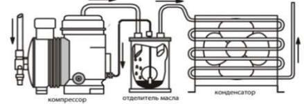
Рабочая температура от -10°C до +150°C, Рабочее давление max. 31бар
