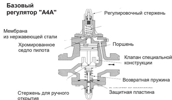
Серия "A4A" включает в себя вентили диаметром от 3/4" до 8" для контроля и регулирования давления "до себя", "после себя" и "разности давления" на вентиле. Каждый из регуляторов может быть доукомплектован аксессуарами для выполнения дополнительных функций, указанных в нижеприведенной таблице, при этом в обозначение модели вводится дополнительная буква.
