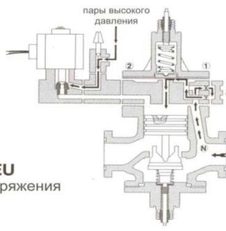
**12.5.1.4. Двухуровневые регуляторы давления "до себя" серии "A4AD" с двумя встроенными пилотами.**
