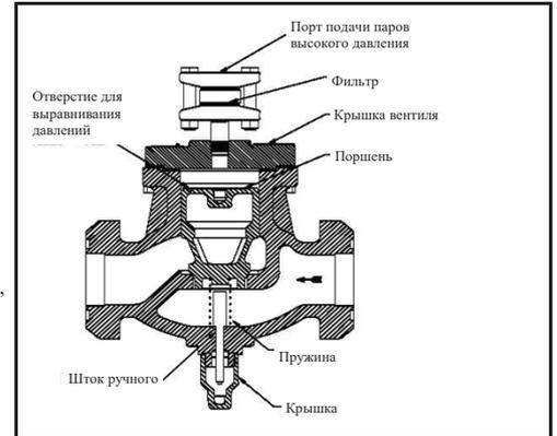
**Внимание !!! клапаны серии "СК2" устанавливаются в любом положении, как на горизонтальных, так и на вертикальных участках трубопроводов.**
