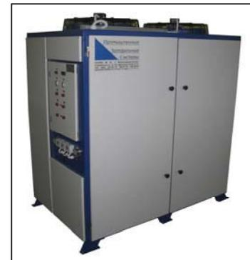
Тип компоновки, использованный в ВТХУ, позволяет установке занимать минимальную площадь машинного отделения, обладая при этом полной заводской готовностью к эксплуатации – все элементы холодильного контура, включая конденсатор, смонтированы на единой раме, установка заправлена хладагентом, все электрические компоненты скоммутированы со щитом управления (также размещенным внутри корпуса).
